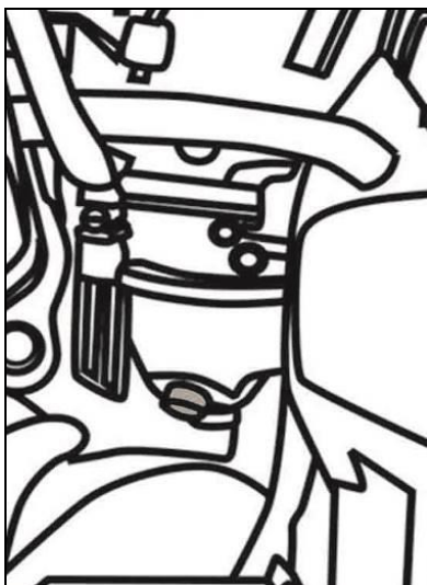
Рис. 16. Слив топлива из карбюратора
